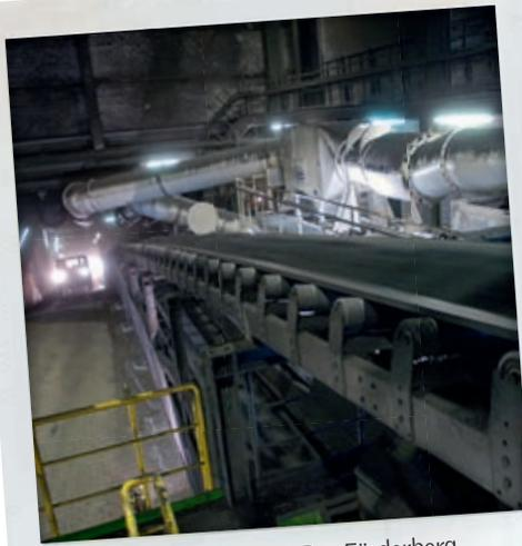
**Die Schrägschachtfahrt:** Der Förderberg verbindet die 5. Sohle mit der Aufbereitungsanlage auf Prosper II.
